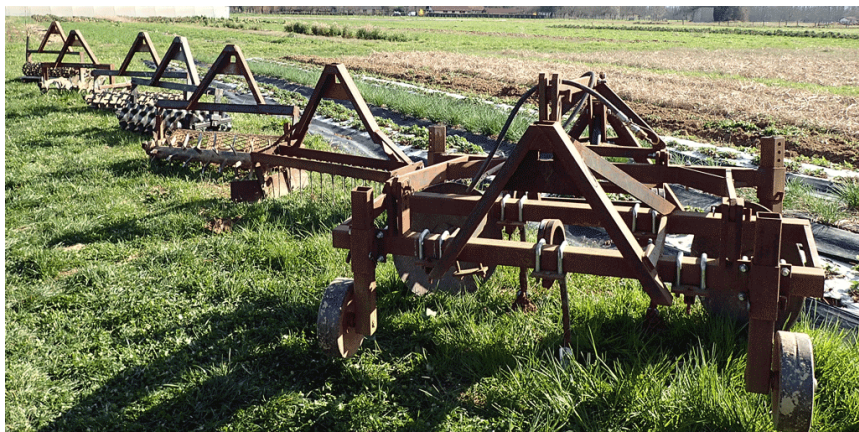
Des accessoires du Cultibutte : de droite à gauche : cultibutte, herse, rouleau fakir, disques gaufrés (prototype), croskicage, bêches roulantes, croskillettes. Source : site internet de l'Atelier Paysan.
